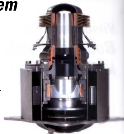
Der Stirlingmotor im Vitotwin 300-W von Viessmann arbeitet ohne Kurbelwelle in einem hermetisch geschlossenen System; er ist deshalb wartungsfrei.
